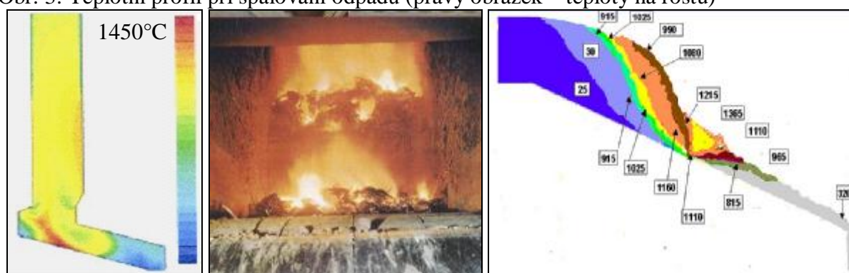
Obr. 3: Teplotní profil při spalování odpadů (pravý obrázek – teploty na roštu)
